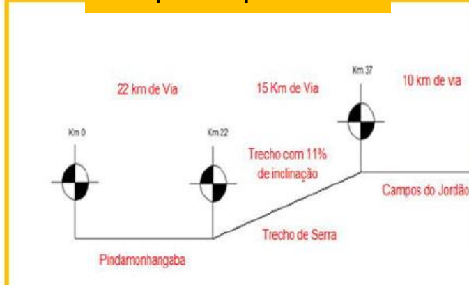
Croqui da via permanente
