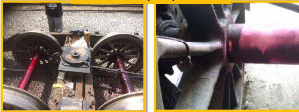
Eixos com o líquido penetrante
